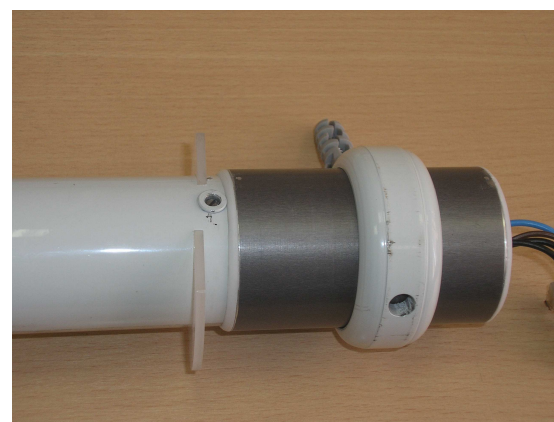
Рис. 8. Макет светодиодного светильника в поликарбонатной трубе с фитингом для стыковки светильников
