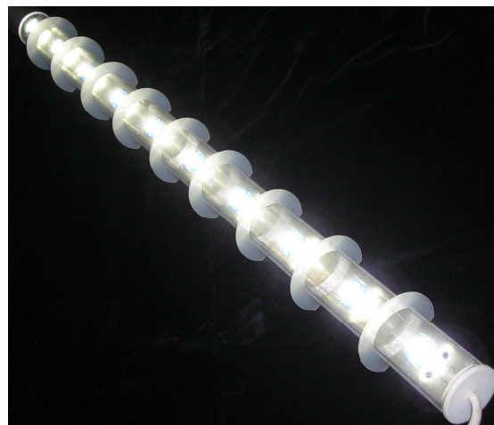
Рис. 7. Макет светодиодного светильника в поликарбонатной трубе
