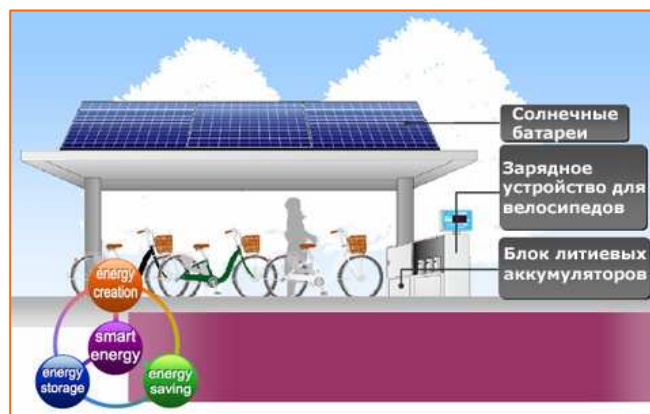
Рис. Пример технологии (и набора аппаратуры) Smart Energy Systems, развиваемой Sanyo в качестве оснащения заводов, школ и магазинов. Система объединяет в себе выработку энергии (солнечные панели), ее накопление (литиевые батареи) и бережное использование (системы распределения по потребителям). В данном случае Smart Energy была приспособлена к велопарковке, хотя имеет множество вариаций по мощности (размеру) и назначению (иллюстрация Sanyo Electric).
