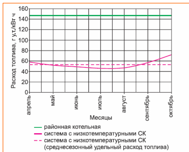
Рис. 4. Удельное потребление топлива на нужды системы теплоснабжения с низкотемпературными СК в комбинации с тепловым насосом и системы на базе районной котельной (для ГВС микрорайона г. Еревана)
